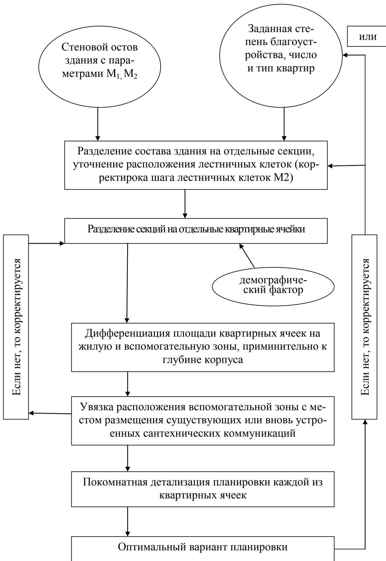
Рис.39. Блок-схема выбора способа перепланировки
