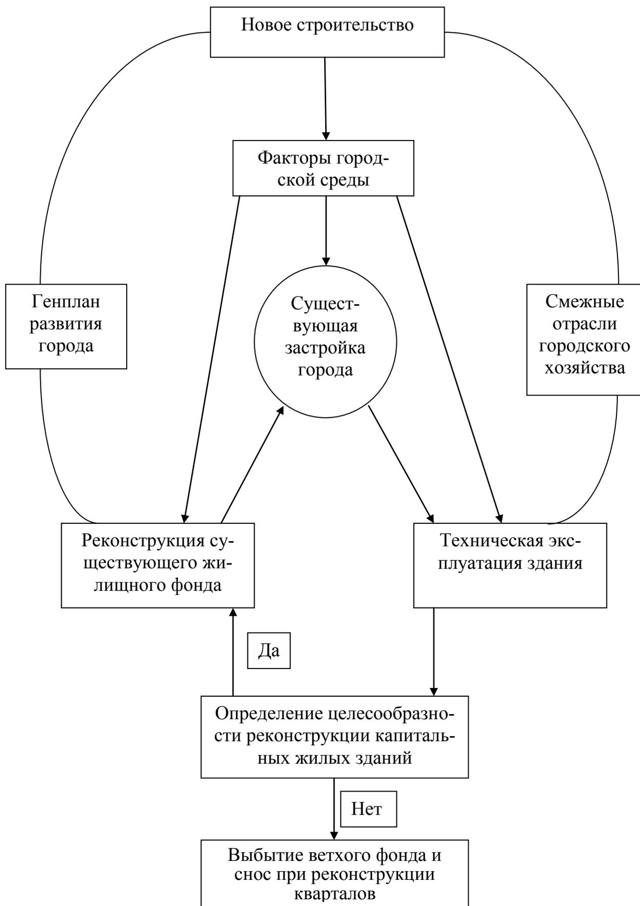
Рис. 39.1. Определение целесообразности реконструкции
