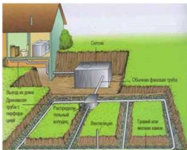
Рис. 31.1. Схема организации локальной канализации
