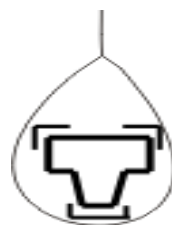
Рис. 59. Строповка подкрановых балок в обхват
