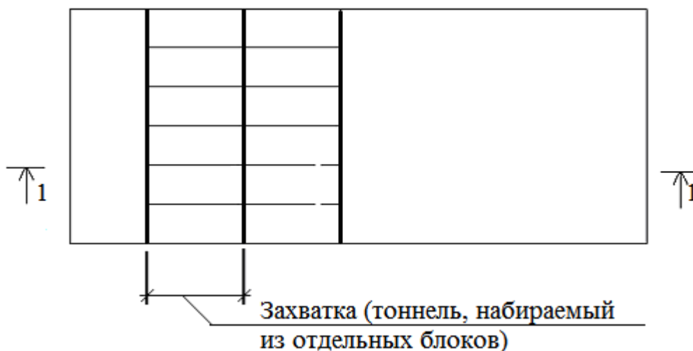
Рис. 97. Установка блоков опалубки в плане
