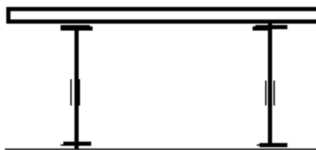
Рис. 174. Опалубка перекрытий типа «стол»
