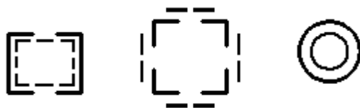
Рис. 17. Разновидности телескопических расстрелов
