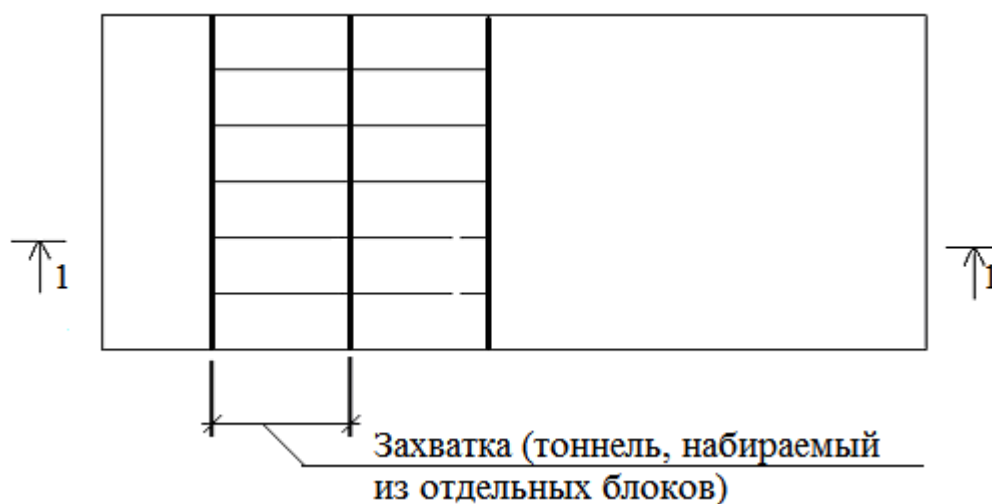
Рис. 182. Установка блоков опалубки в плане
