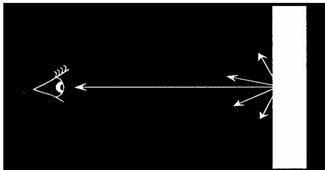
*Рис. 5. Схема зрительного восприятия фотолюминесцентных знаков безопасности*
