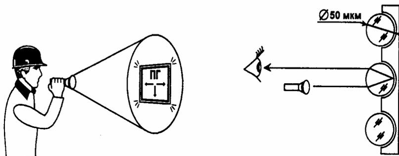
*Рис. 4. Схема зрительного восприятия световозвращающих знаков безопасности*
