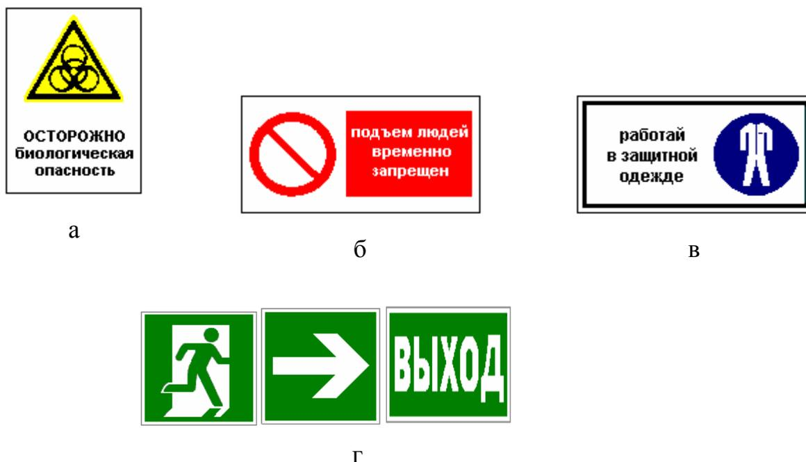
*Рис. 1. Комбинированные знаки безопасности: а – текст расположен ниже знака безопасности; б – текст расположен справа от знака безопасности; в – текст расположен слева от знака безопасности; г – комбинированный знак для указания направления движения*
