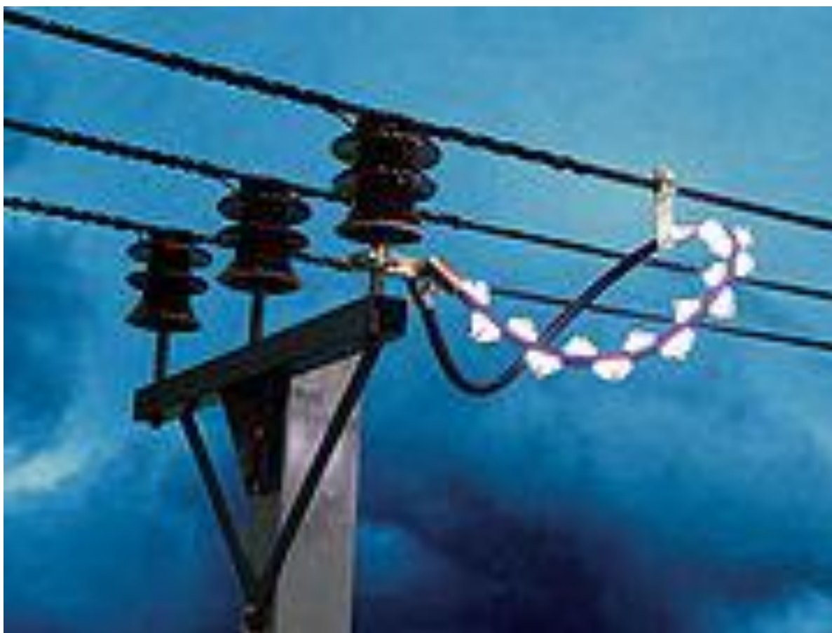
Рис. М4. Момент срабатывания разрядника при воздействии грозового импульса перенапряжения во время лабораторных испытаний
