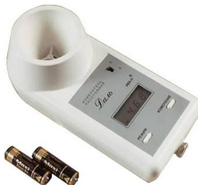
Рисунок 27 – Внешний вид ультразвукового измерителя расстояний "Даль"
