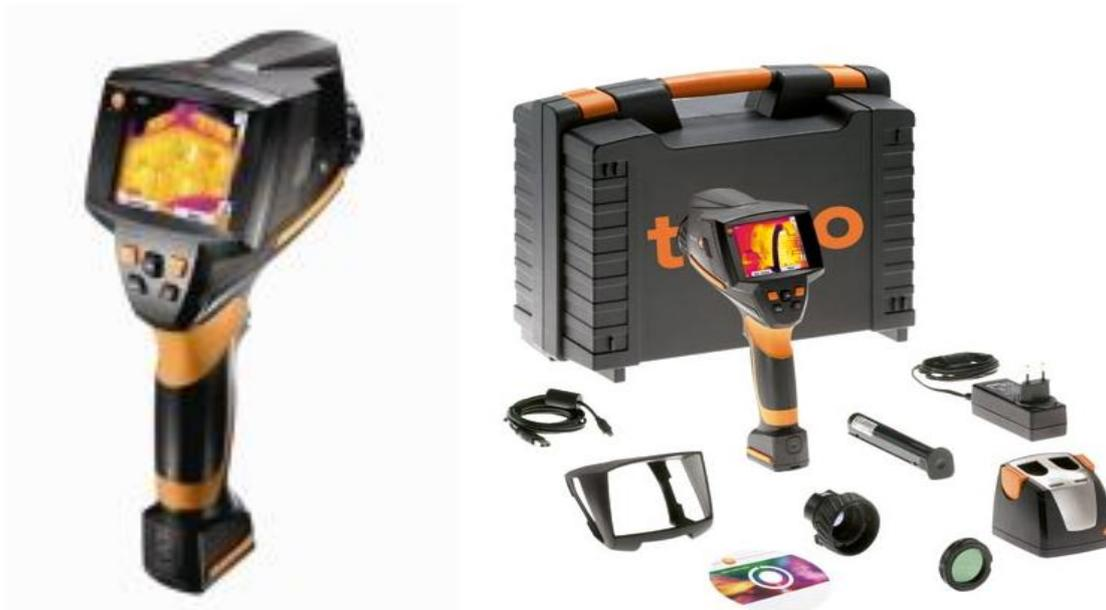
Рисунок 15 – Внешний вид тепловизора testo 875-2i
