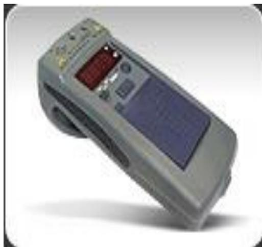
Рисунок – 9 Прибор для измерения абсорбционных характеристик
