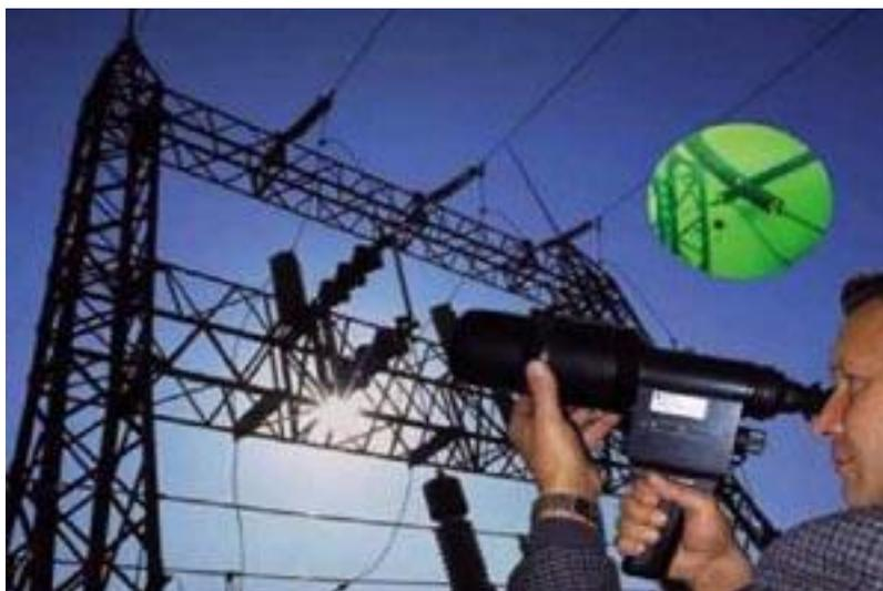
Рисунок 24 – Внешний вид прибора "Филин-6"
