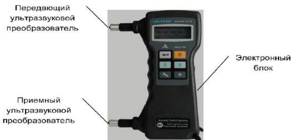
Рисунок 21 – Внешний вид ультразвукового тестера УК 1401М
