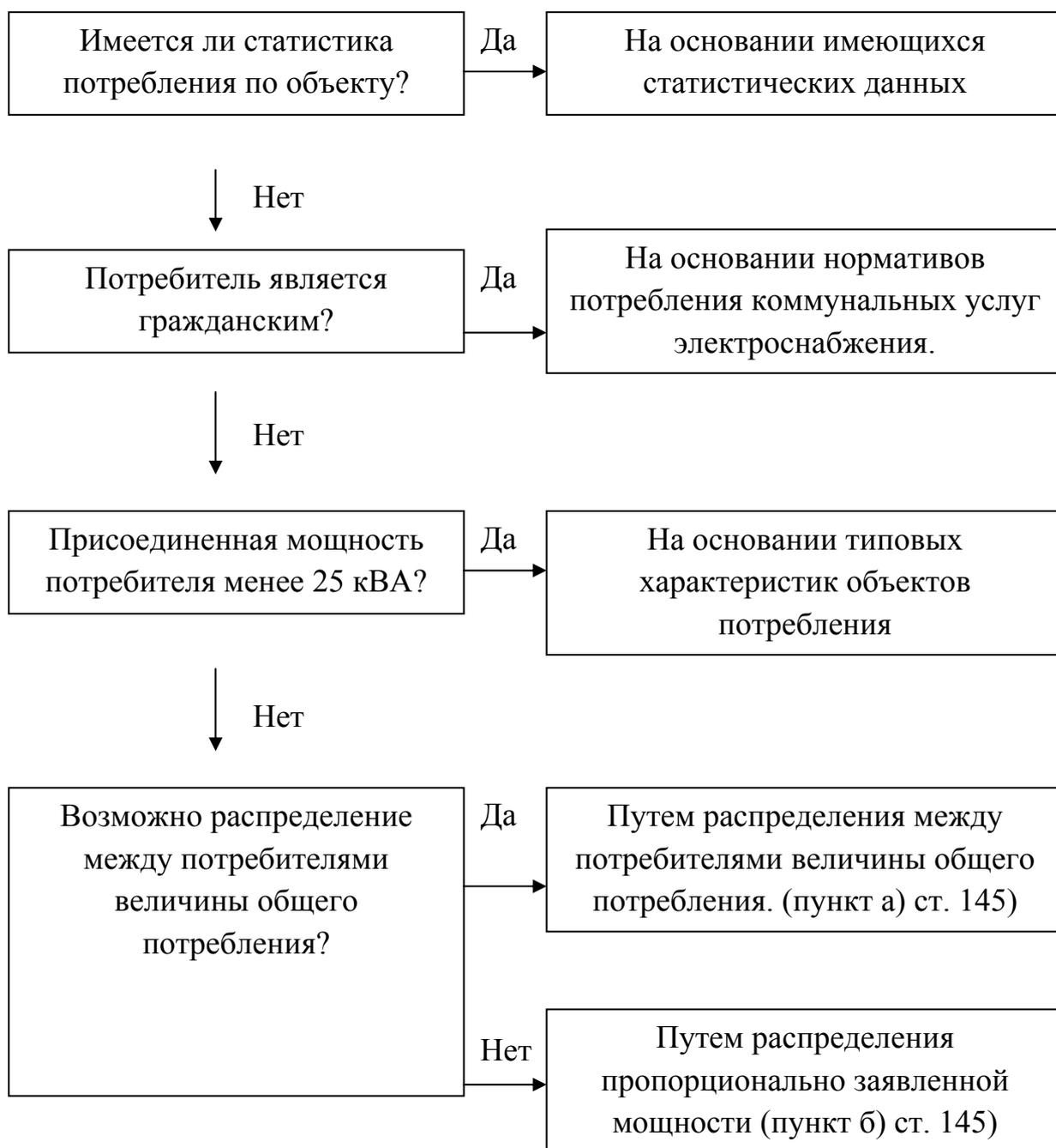
Рис 1. Алгоритм определения объема потребления энергии в случае выхода из строя или утрате расчетного прибора учета и отсутствии контрольного прибора учета
