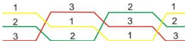
Рис.3.4 – Цикл транспозиции одноцепной линии
