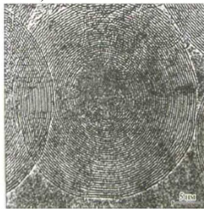
Рис. 61. Электронная микрофотография фуллереновой луковицы, содержащей в центре нанокристаллит алмаза
