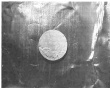
Рис. 25. Компактный образец нанокристаллического оксида приготовленный методом испарения, конденсации и компактирования, предложенным Г. Глейтером. Диаметр образца 5 мм, толщина — около 1 мм, средний размер зёрен в образце — 20 нм (Институт теоретической и прикладной физики Штутгартского университета, Штутгарт, Германия)
