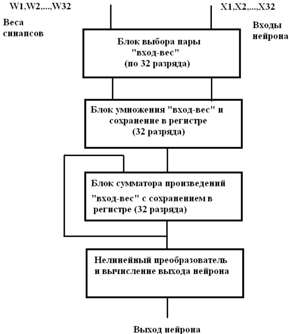
Рис.9.3. Структурная схема нейрона
