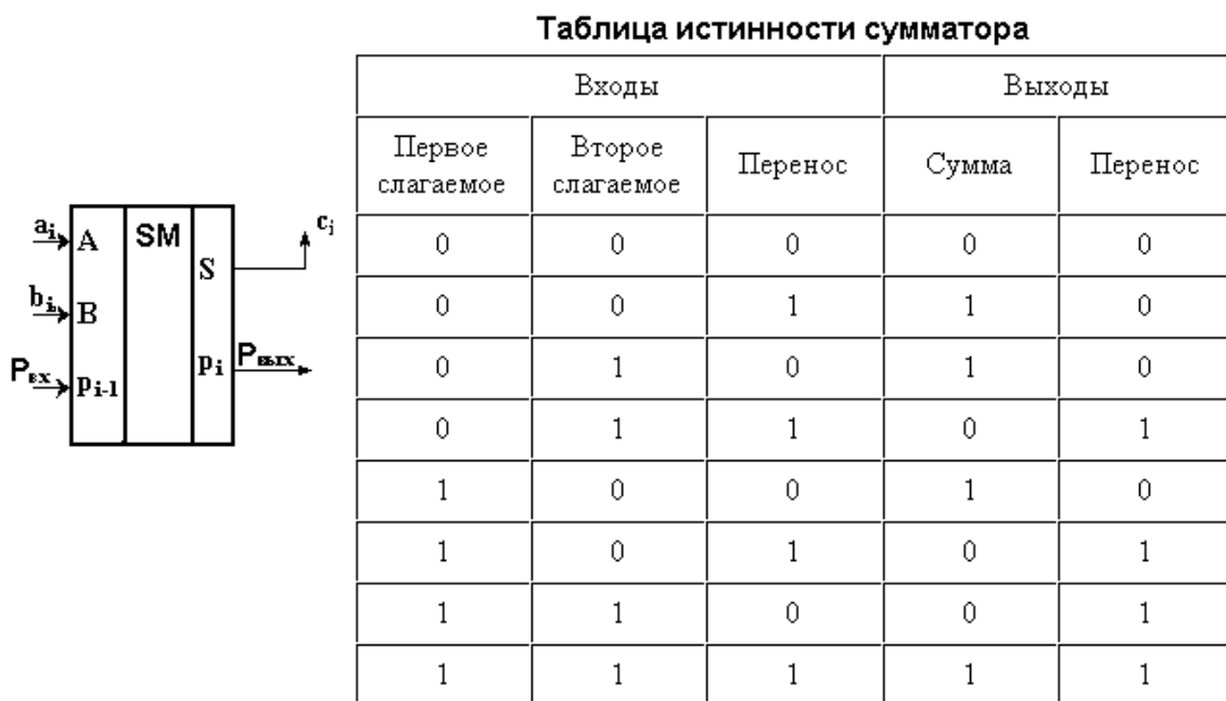
Рис. 12. Обозначение и таблица истинности сумматора.
